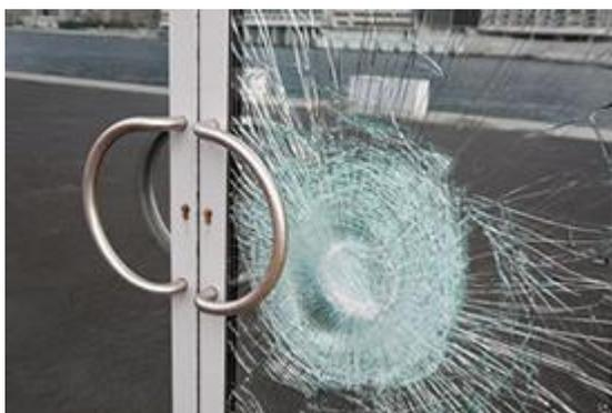
На стекло нанесена защитная пленка АЗ, обладает большей механической прочностью и повышенной безопасностью: даже если по нему будет нанесен удар такой силы, что стекло разобьется, оно не разлетится на острые и опасные осколки – их удержит прочная защитная пленка. Эта особенность обеспечивает ещё одно важное преимущество: если безопасное стекло разбито или треснуло в результате механического воздействия, оно может продолжать выполнять ограждающую функцию до момента замены стеклопакета.
