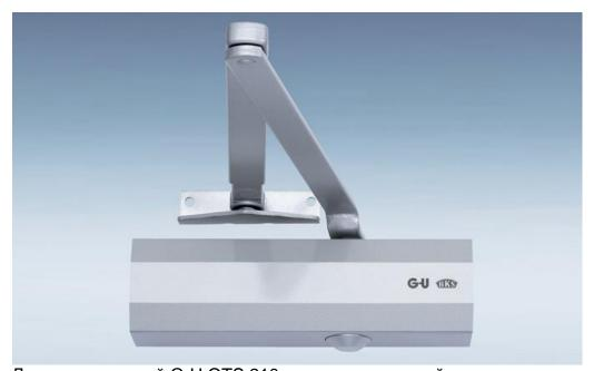
Доводчик дверной G-U OTS 210 — верхнеподвесной, с регулируемым усилием закрывания путем перестановки колена. Доводчик оснащен высоконадежным игольчатым осевым подшипником. Есть вариант доводчика с функцией фиксации двери в открытом состоянии в диапазоне углов от 70° до 150°. Угол открывания и закрывания двери — 180°. Полностью управляемое закрывание от любого угла. Плавная регулировка скорости закрывания винтом
