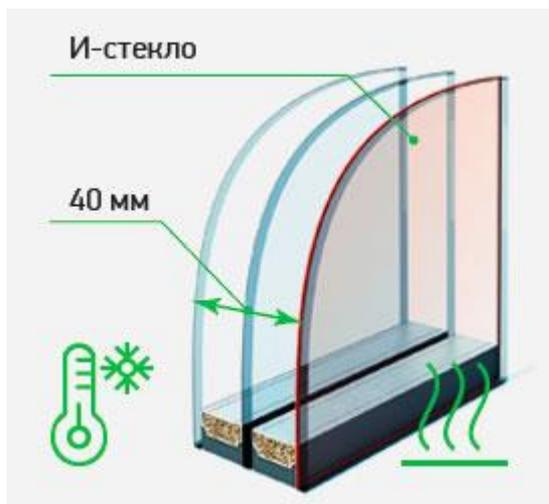
«Утепленный» стеклопакет включает энергосберегающее i-стекло (И-стекло) Guardian ClimaGuard N, которое снижает теплопотери более чем на 50% по отношению к обычному стеклопакету, препятствует образованию конденсата, обладает высокой светопропускающей способностью, как и обычный стеклопакет (>70%), удерживает в помещении длинноволновое инфракрасное излучение (от батарей и нагретых предметов), на долю которого приходится до 70% потерь тепла.
