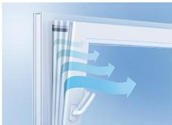
Система многоступенчатого проветривания SPL компании G-U эффективно решает проблемы образования конденсата и нехватки кислорода, обеспечивая постоянный приток свежего воздуха, даже если створка открыта всего на 5мм. Поступающий воздух успевает прогреться и не приводит к резкому выхолаживанию помещения, даже если створка приоткрыта постоянно.
