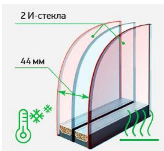
Включает 2 энергосберегающих i-стекла (И-стекло) Guardian ClimaGuard N, которые снижают теплопотери, препятствуют образованию конденсата, обладают высокой светопропускающей способностью, удерживает в помещении длинноволновое инфракрасное излучение (от батарей и нагретых предметов).
