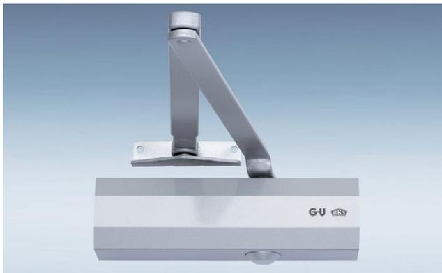
Доводчик дверной G-U OTS 210 – верхнеподвесной, с регулируемым усилием закрывания путем перестановки колена. Доводчик оснащен высоконадежным игольчатым осевым подшипником. Есть вариант доводчика с функцией фиксации двери в открытом состоянии в диапазоне углов от 70° до 150°. Угол открывания и закрывания двери – 180°. Полностью управляемое закрывание от любого угла. Плавная регулировка скорости закрывания
