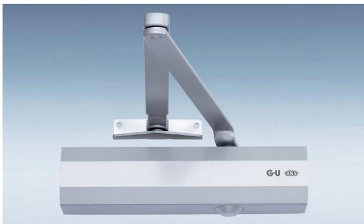
Доводчик G-U OTS 430 - верхнеподвесной, с зубчатой передачей, для дверей левого и правого открывания. Применим на стандартных дверях с шириной створки до 1250 мм.
