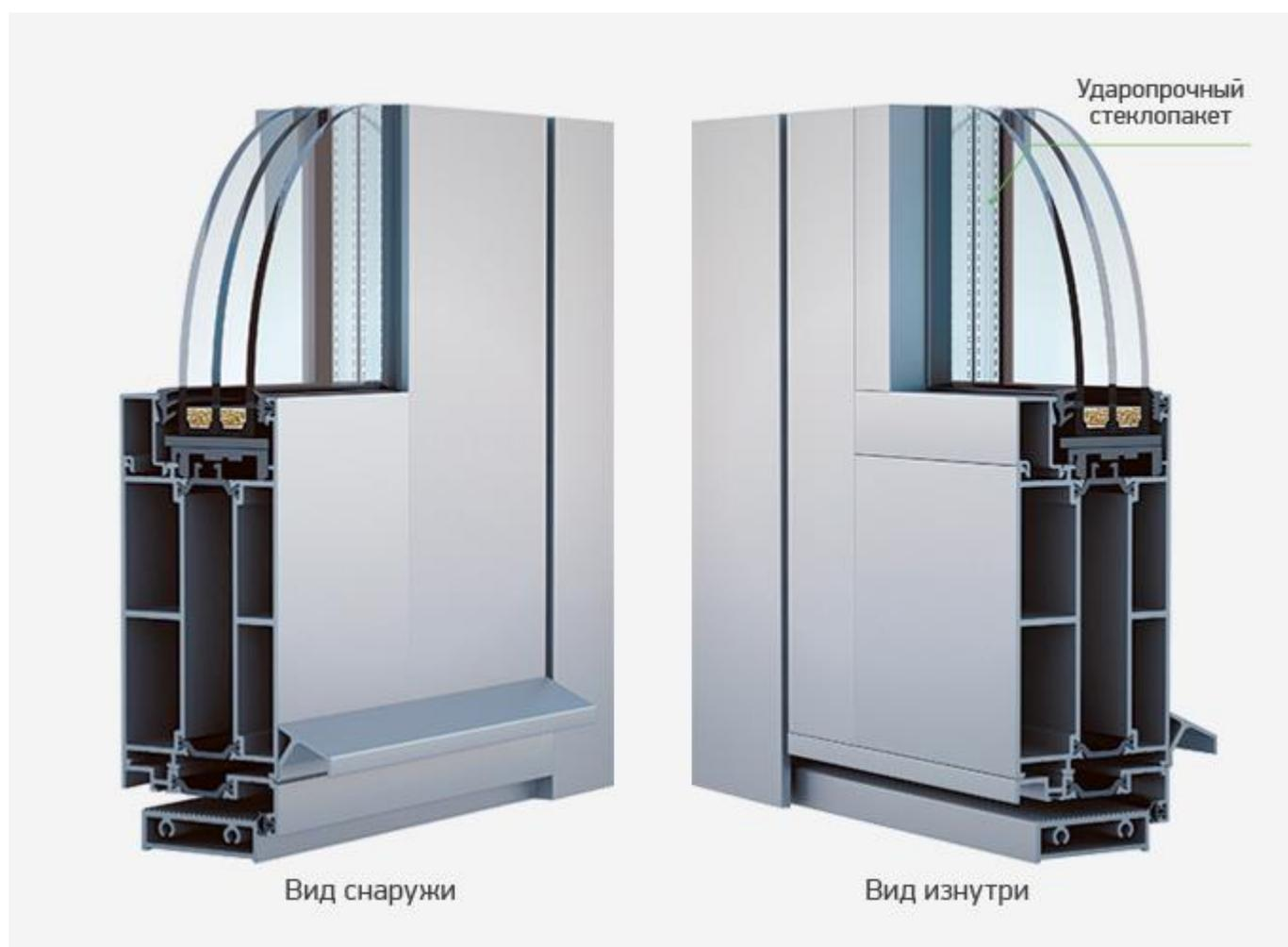
Профильная система из алюминия ALUTECH ALT W62 (теплоизолированная) предназначена для изготовления «тёплых» оконных, дверных и витражных конструкций, отвечающих современным требованиям по термо- и звукоизоляции. Комбинированный профиль с монтажной глубиной 62 мм состоит из двух алюминиевых профилей, соединенных между собой стеклонаполненными полиамидными вставками. Полиамидные элементы в конструкции основных профилей выполняют функцию терморазрыва и
