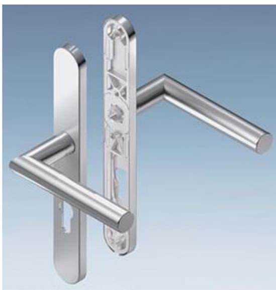
Нажимные ручки из нержавеющей стали двигаются плавно, бесшумно и с приятным усилием. Сквозное резьбовое крепление с прочными крепежными элементами гарантирует надежную посадку и предотвращает выламывание фурнитуры с применением усилия. От грубого выдергивания или выворачивания запирающего цилиндра защищает накладка. Имеется подпружиненный механизм для выравнивания ручки. Закаленные элементы внешней накладки препятствуют попыткам высверливания.
